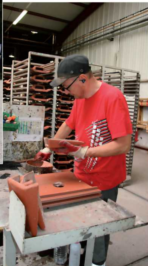
Assemblage des pièces pour chatières, une des rares opérations manuelles réalisées en atelier.
