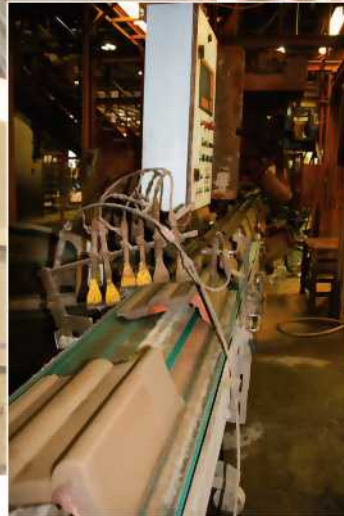
Le béton est dirigé dans un entonnoir et tombe dans les moules en aluminium, acheminés via un tapis roulant, préalablement huilés pour faciliter le démoulage.
